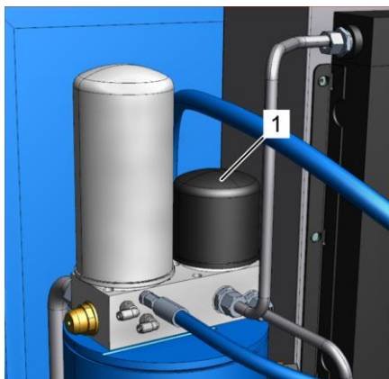
Рис. 46: Демонтаж фильтра охлаждающей жидкости
